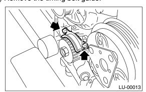
13) Remove the crankshaft sprocket.
